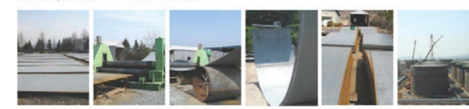
장크 도로 도장 ▶ Bending기 ▶ Bending 작업 ▶ 도막상태 확인 ▶ 아워 적재 ▶ 현장 조립
